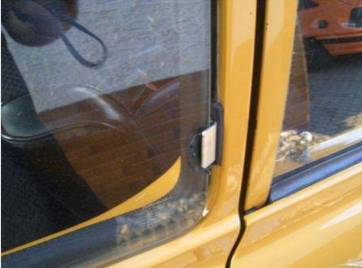
Den alten Kleber mit einem Schaber entfernen. Den Rest kann man dann mit Aceton reinigen. Zugleich ist es auch noch entfettend für den späteren Klebevorgang:
